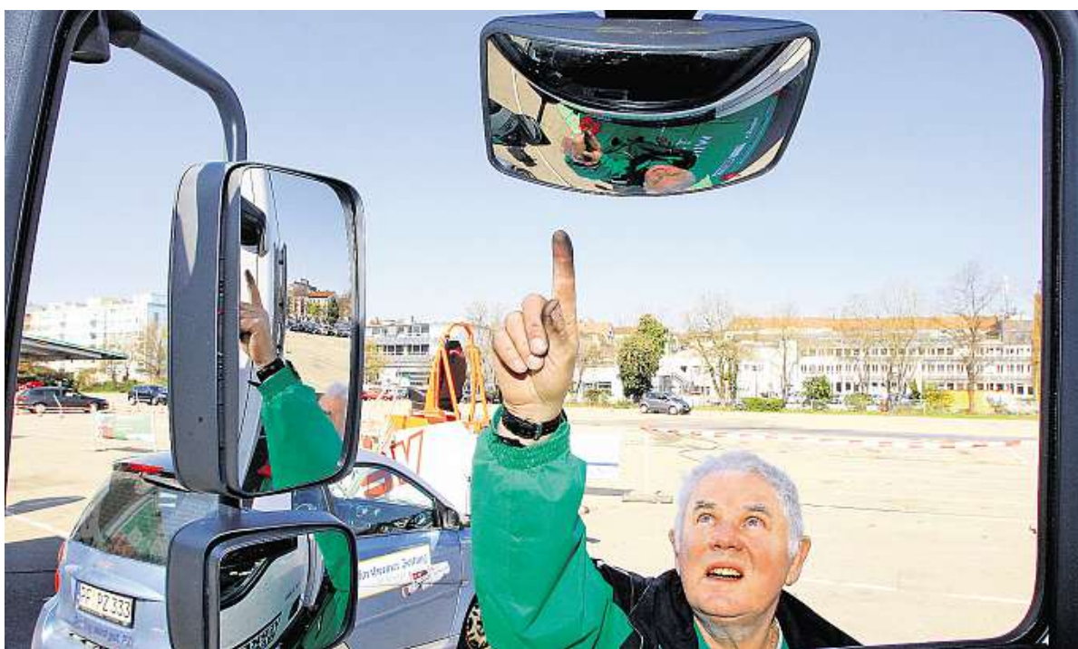
Peter Ludwig zeigt: Mit mehreren Außenspiegeln gibt es keinen „toten Winkel“ mehr.
